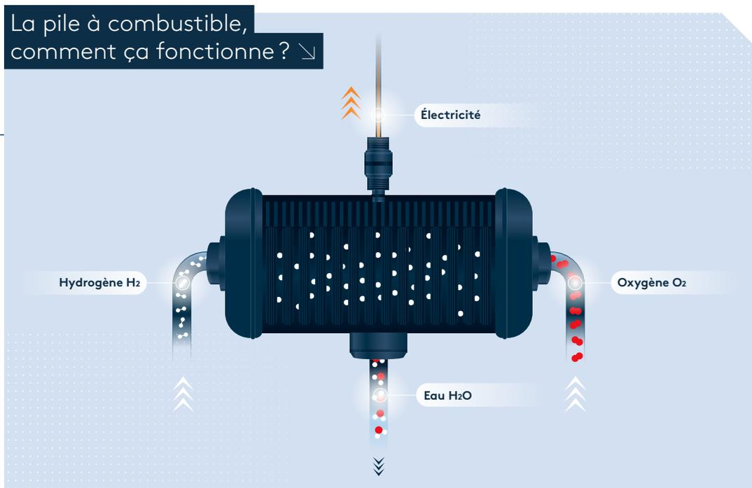
Dans la **pile à combustible**, une réaction d'oxydoréduction permet de produire de l'électricité et de la chaleur. Comment ?
